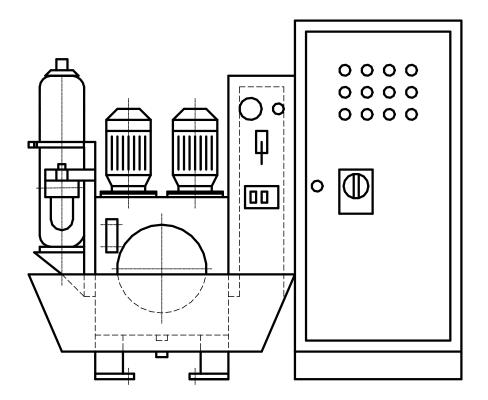
MVA - Ölhydraulik-Versorgungseinheit
